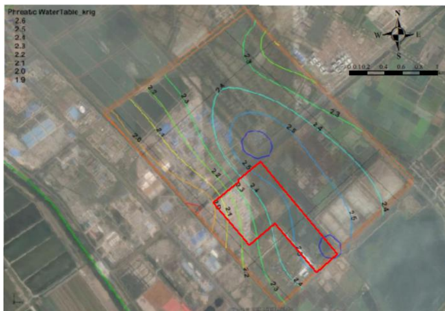
图 6.4.2-3 潜水位等值线图
